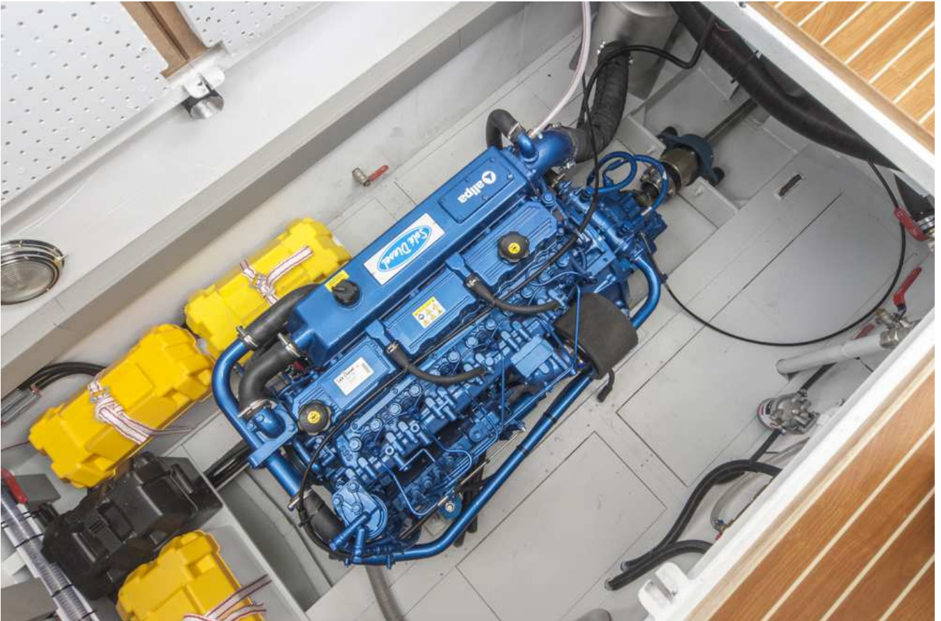
Klein aber stark genug: Die 95-PS-Maschine von Mitsubishi, die diese 10-Tonnen-Yacht antreibt. Foto: Dieter Wanke
