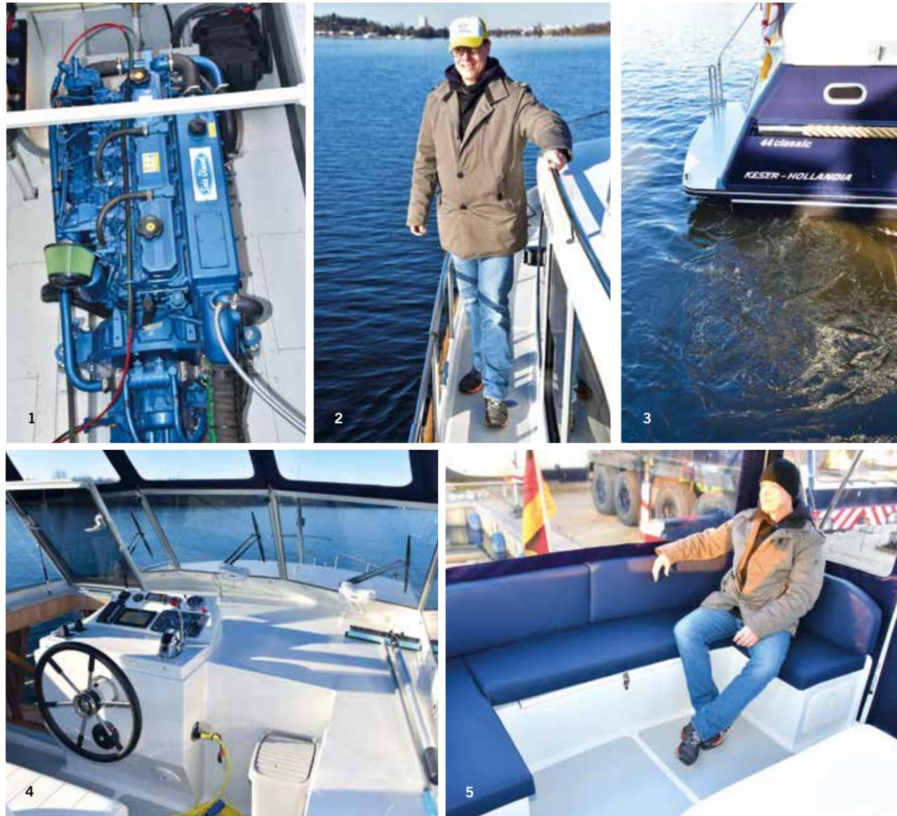
1. Der durchzugsstarke Solé-Sechszylinder mobilisiert 56 kW, also 76 Pferdestärken
