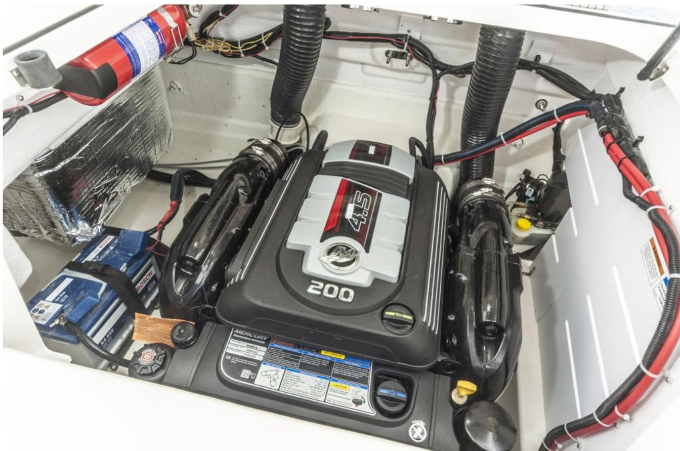
Mit der 4,5-Liter-Mercurier-Maschine, die 149 KW leistet, erreichte die VR 5 im Test fast 40 Knoten. Foto: Dieter Wanke
